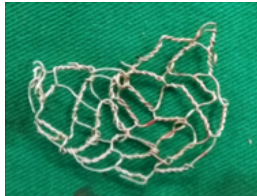
Figure 1 : Plaque grillagée préformée au fil d'acier 4/10ème
